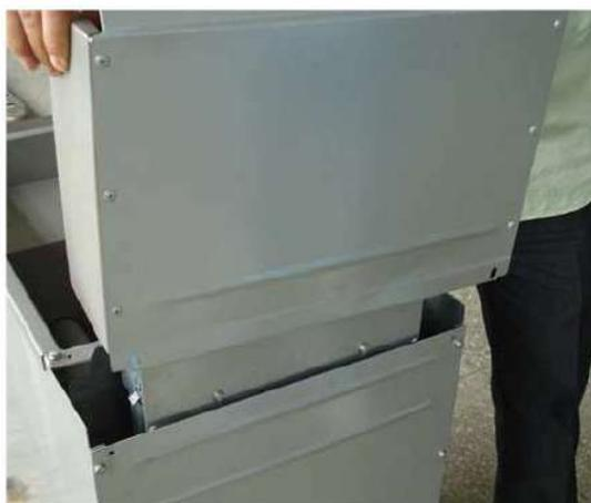
4. Asegure la cubierta de la chimenea con los cuatro tornillos, dos en la parte posterior y los otros dos en cada lado usando el dado hexagonal de 5/16".
